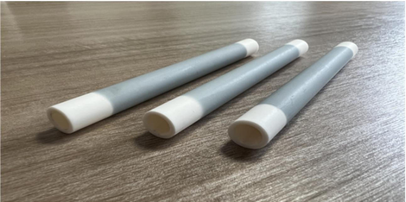
石英管和陶瓷发热管的缺点1、石英管是用二氧化硅制造的特种工业技术玻璃，是一种非常优良的基础材料。石英管具有一系列优良的物理、化学性能用于电火桶,电烤火炉,电取暖器里面,起发热作用化学性能：耐高温，石英玻璃的软化点温度约1730℃，可在1100℃下长时间使用，短时间较高使用温度可达1450℃。耐腐蚀，除氢氟酸外，石英玻璃几乎不与其他酸类物质发生化学反应，其耐酸能力是陶瓷的30倍，不锈钢的150倍，尤其是在温度较高下的化学稳定性，是其他任何工程材料都无法比拟的。2、陶瓷发热管具有耐腐蚀、耐高温、寿命长、高效节能、温度均匀、导热性能良好、热补偿速度快等优点，而且不含铅、镉、汞、六价铬、多溴联苯、多溴二苯醚等有害物质。定义原理:以高热导率氧化铝瓷为基体，耐热难熔金属作为内电极形成发热电路，通过一系列特殊工艺在1600℃高温下共烧而成的一种新高热节能的发热体。广西陶瓷发热管常州陶瓷
